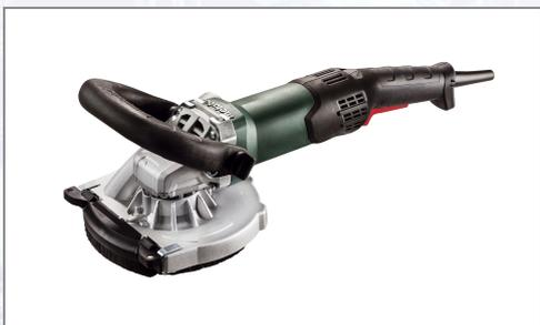
Zum effektiven Anschleifen und Abtragen von Beton, Estrich und Beschichtungen mit Diamanttopfscheiben. Hohes Drehmoment und Überlastfähigkeit für harte Anwendungen im Dauereinsatz. Randnahes Arbeiten durch unverlierbares Segment zum Aufklappen. Elektronischer Sanftanlauf für ruckfreies Anlaufen. Geringes Gewicht, ideal zum Schleifen im Wand- und Deckenbereich. Technische Daten: -
