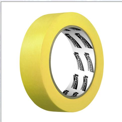
Dünnes, UV-beständiges Standard-Abdeckband aus Spezialpapier (Washi) für scharfe Farbkanten auf glatten und leicht rauen Untergründen. Gute Vernetzung und Standard-Imprägnierung. Für Basis-Malerarbeiten. Technische Daten: - Träger: Washi, UV-beständig, - Stärke: 0,08 mm, - Kleber: Acrylat, - Klebkraft Stahl: 1,1 N/ 10 mm, - Reißfestigkeit: 33,9 N/ 10 mm, - Reißdehnung: 4,0 %, - Hitzebeständigkeit: bis 100 °C, - UV-Beständigkeit: außen: bis zu 4 Wochen, innen: bis zu 3 Monate.
