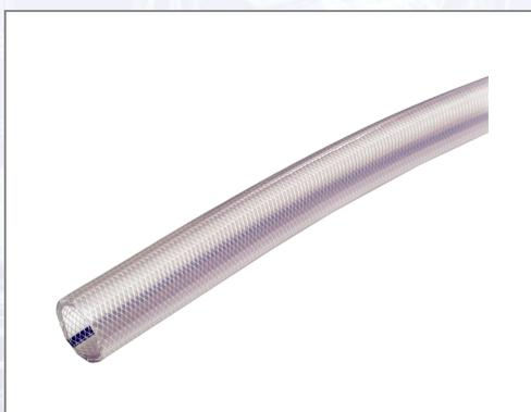
Glasklarer, flexibler Weich-PVC-Schlauch, glatt mit druckfester Polyestereinlage. Geeignet als Wasser- oder Druckluftschlauch. Geeignet für chemische, nicht besonders aggressive Flüssigkeiten. - Betriebsdruck: 7 bar (18 °C), - Innen-d= 51 mm, - Wandstärke: 6,5 mm, - umweltfreundliches Material in Lebensmittelqualität.
