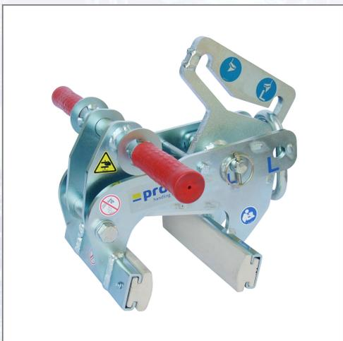
Speziell entwickelt für das Versetzen von L-Steinen oder dergleichen. Aufhängeöse kann dem Schwerpunkt der Elemente angepasst werden, damit diese senkrecht hängen. Serienmäßig ausgerüstet: - Umsteckmöglichkeit um Schwerpunktlagen des Greifguts auszugleichen, - Umschalten von Greifen und Lösen über die Aufhängung, - graue austauschbare Profilmummileiste.
