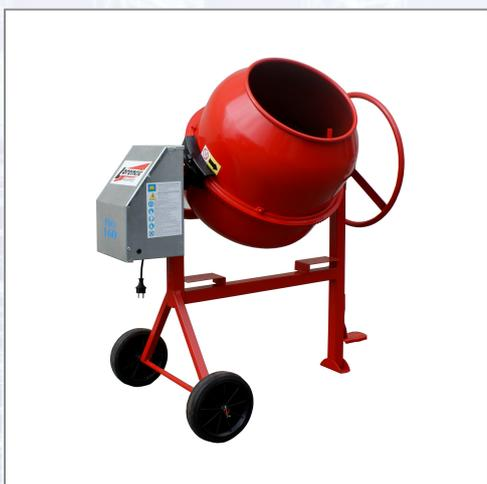
Technische Daten: pulverbeschichtet RAL 3020, Motor: Wechselstrom 230 V, 850 W, spritzwassergeschützter Antrieb Klasse IP 44, verzinktes Motorgehäuse, große Mischschaufeln für optimales Mischverhältnis, Zahnrad: Guss, Trommelinhalt: 150 Liter, Bedienung: Handrad, außenliegende Lagerbuchse, 2 Staplerlaschen für leichten Transport, Abmessungen (LxBxH): 1190x665x1350 mm, Gewicht: 59 kg.
