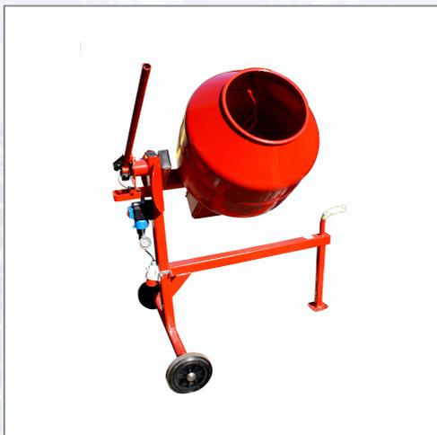
Der bewährte Kipptrommelmischer mit zweckmäßiger Bedienung durch Bedienelemente, Kipphebel und Schalter auf der Seite. Optimalste Zugänglichkeit für Entleerungsbehälter. Effiziente und einfache Handhabung auf Baustellen. Ausgestattet mit einem seit Generationen bewährten, robusten und wartungsfreien 2-stufigen Getriebe. Lackierung in RAL3020. Technische Daten: Antriebsmotor: 230/400 V/0,75 kW, Trommelinhalt: 160 Liter, Getriebe: 27 U/min, Abmessungen (LxBxH): 1320x870x1680 mm, Gewicht: 101 kg.
