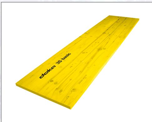
Schalttafel im mittleren Qualitäts- und Preissegment für den täglichen Baustelleneinsatz und für alle herkömmlichen Anwendungsbereiche. Kreuzweise verleimte Dreischichtplatte aus Fichte, beidseitig geschlossene Oberfläche mit Melaminharz-Beschichtung, hochwertige Verleimung, umlaufende und beschichtete Randleiste. Fertigung nach Ö-Norm B 3023.
