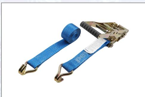
Das anwenderfreundliche System zum Niederzurren schwerer Ladungen erlaubt durch die Langhebel-Ergo-Ratsche ein Spannen auf Zug. Die höchste Spannkraft STF reduziert die erforderliche Anzahl an Gurten deutlich und spart Verladezeit. Normale Spannkraft: 500 daN, Zurrkraft LC im geraden Zug 2500 daN, in Umreifung 5000 daN.
