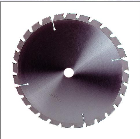
Das Hartmetall-Sägeblatt, nagelfest und schallgedämpft, für Baukreissägen - zur Verwendung von groben Brenn- und Bauholzchnitten. Unempfindlich gegen Betonreste und bedingt nagelsicher (nicht geeignet für Stahlnägel etc.). Das Stammblatt hat eine Stahlgüte von C75. Bohrung 30 mm. - Trapezzahn 32Z
