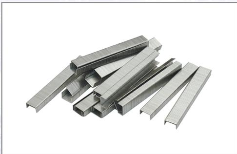
Flachdrahtklammer für Isolierung, Kunststofffolien, Deckenplatten, Teppichboden oder Bedachung. Verzinkt oder nichtrostender Stahl AISI-304 (A2 Klasse). Klammerspitze: Meißelspitze oder Sägespitze, Klammerrückenbreite: 10,6 mm, Klammerbreite: 1,3 mm, Härte: High Performance. Klammerlängen 6-16 mm.
