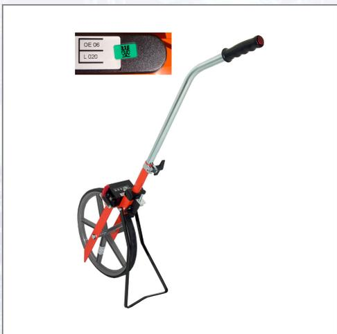
Präzises Zählwerk für exakte Messergebnisse. Zählwerk zählt auch rückwärts. Nullstellhebel direkt am Zählwerk. Integrierte Bremse, klappbare Führungsstange, Abstellbügel. Technische Daten: Messbereich: 9999,99 m/cm - Ablesung, Raddurchmesser: 318,5 mm, Radumfang: 1,00 m, Gesamtgewicht: 3,3 kg.
