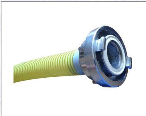
Leichter flexibler und knickfester PVC-Spiralsaug- und Druckschlauch mit Hart-PVC-Spirale. Leicht zu reinigen, wetterfest und beständig gegen viele Chemikalien. Farbe: transparent mit gelber Spirale, Temperaturbereich: -5 °C bis +60 °C.
