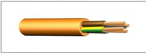
Kälteflexibel, für höchste Anforderungen an die Abriebfestigkeit, Kerbzähigkeit und Ölbeständigkeit, extrem temperaturbeständig. Kupferleiter feindrätig. Aderisolation aus Gummi-Mischung (EL6), Außenmantel aus Polyurethan (PU).
