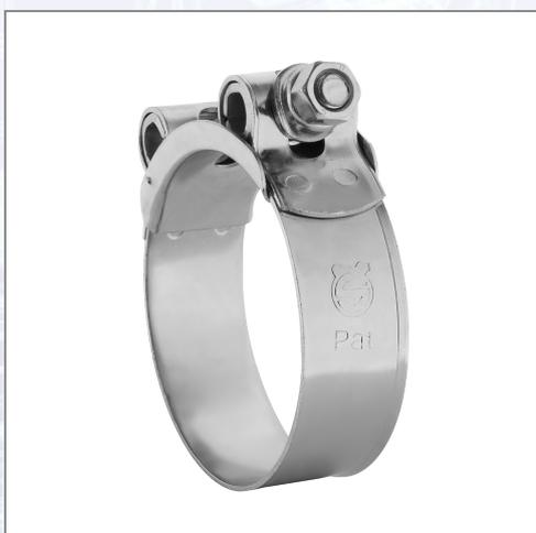
Eine widerstandsfähige Klemme, die Dichtheit bei hohen Drücken garantiert. Das Schraubensystem basiert auf einer hochfesten Sechskantmutter, die ein einfaches Anziehen mit jedem Werkzeugtyp ermöglicht. Ihre abgeschrägten Kanten verhindern Einschnitte in Rohren und Kunststoffen. Material: verzinkter Stahl.
