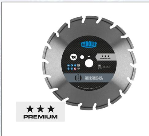
Premium-Fugenschnittblatt C7SW (FSA) für den Einsatz in Maschinen mit Leistung bis 15 kW. Bearbeitbare Materialien: Asphalt mit weichen bis sehr harten Zuschlägen. Lasergeschweißt, mit Schutzsegment gegen vorzeitigen Verschleiß (Undercutting-Effekt). Messbohrung zur Verschleißkontrolle.
