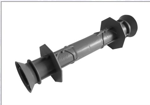
OKTAGON ist eine einteilige Schalungsspannstelle in besonders großzügiger Ausführung aus HDPE. Beständig gegen am Bau übliche Säuren und Laugen. Aus einem Stück gefertigt (PVC-frei). Garantie für die Wasserdichtheit des Innenrohres (bis 5 bar Wasserdruck geprüft).
