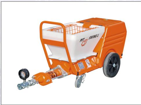
Die PFT SWING ist eine universelle Förderpumpe wahlweise mit festem oder elektronisch stufenlos regelbarem Direktantrieb. Dünnflüssige, pumpfähige und lösungsmittelfreie Materialien können gepumpt, verpresst und gespritzt werden. Einsatzgebiete: Für alle pumpfähigen Nassprodukte und pastöse Materialien wie: Klebemörtel, Kunststoffharz-Silikatputze, Oberputze bis 4 mm Körnung, Zierputze, Spritzputzpachtel und im Bereich WDVS. Technische Daten:
