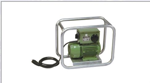
In Permanentmagnet-Ausführung. Umrichtung von 230 V auf 42 V. Speziell für die Anwendung von Rüttlern. Robuste Bauweise und geringe Reparaturanfälligkeit. Schutzart IP 44. Zum Anschluss von 1 Rüttler bis LATI 68. Technische Daten: - Abgabe: 42 V / 16,5 A / 200 Hz, - Primärspannung: 230 V, - Leistungsaufnahme: 1,8 kVA / 7,9 A, - Gewicht: 15,5 kg.
