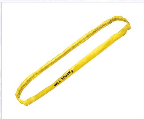
Rundschlinge aus Polyester, Doppelmantel. Hohe Tragfähigkeit bei geringem Eigengewicht. Tragfähigkeit farbcodiert. Sehr flexibles Material, keine Beschädigungen am Hebegut. SF 7:1. Entsprechend EN 1492-2 sowie Maschinen-Richtlinie 2006/42/EG. WLL: direkt: 3000 kg, umgelegt: 6000 kg, geschnürt: 2400 kg, umgelegt  $\beta = 45^\circ$ : 4200 kg, umgelegt  $\beta = 60^\circ$ : 3000 kg.
