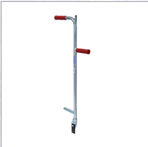
Zum Ausrichten der noch nicht abgerüttelten Verbundsteine. Mit zwei Handgriffen, einem Fußauftritt und einer Hammerfläche zum Eintreiben in die Fugen mittels Hammer. Mit auswechselbarer, robuster, scharfkantiger Spreizklinge aus gehärtetem Federstahl zum Eintreiben in die Fuge. Dauerhafter Oberflächenschutz durch galvanische Verzinkung. Gewicht: 1,5 kg.
