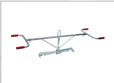
Speziell zum Versetzen von Bordsteinen. Durch einseitige Winkelauflage, die am bereits verlegten Bordstein aufgesetzt wird, ist ein Ansetzen dicht an dicht möglich. - Längsgreifend, dadurch einsetzbar bei engsten Verhältnissen. - Keine Auslenkung der Richtschnur. - Alle Typen mit Einhängeöse ausgerüstet. Technische Daten: - galvanisch verzinkt, - Greifbereich: 500-1045 mm, - Eintauchtiefe: 40 mm, - Backenlänge: 100 mm, - Tragfähigkeit: 100 kg, - Gewicht: 12,0 kg.
