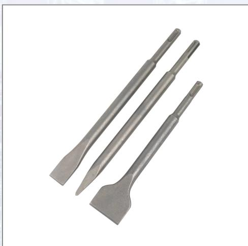
Geeignet für den Einsatz in SDS-Plus Bohrhämmern mit Drehstopp für leichte Meißelarbeiten in Putz, Mauerwerk, Fliesen etc. Set bestehend aus: 3 Meißel mit je 250 mm Arbeitslänge (20er und 40er Flachmeißel sowie Spitzmeißel).
