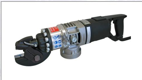
Dieses Gerät ist ein elektrohydraulisches Schneidegerät zum Schneiden von Baustahl; bis zu einem maximalen Durchmesser von 16 mm. Nennspannung: 230 V 50 Hz, Höchste Drehzahl: 10000 U/min, Stromaufnahme bei Belastung 5,3 A, Leistungsaufnahme bei Belastung 1100 W, Schneidkraft 17,4 t, Gewicht 9,5 kg.
