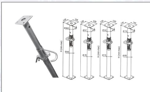
Feuerverzinkte Industriedeckenstützen gemäß EN 1065 für den harten Baustelleneinsatz. Feuerverzinktes Außengewinde. Innenrohr: je nach Größe 57 bis 76 mm, Außenrohr: je nach Größe 70 bis 89 mm, Kopf- und Fußplatten: 120x120x6 mm. Deckenstütze Klasse D, feuerverzinkt, Außengewinde, Bruchlast: 37,60- 23,90 kN, Gewicht: 19,70 kg.
